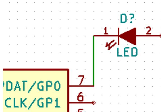
33. この処理を繰り返して以下の全てのコンポーネントの配線を済ませます。ワイヤを終端するにはダブルクリックをします。VCC と GND のシンボルへの配線は、VCC シンボルなら下部に、GND シンボルなら上部中央にタッチします。下のスクリーンショットを見てください。
