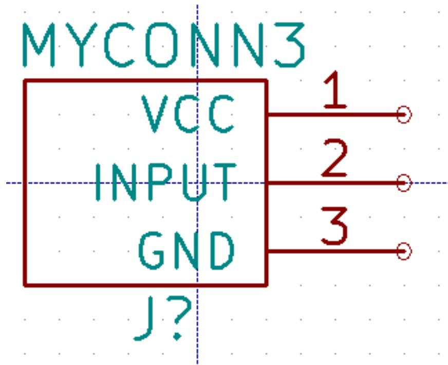
8. 矩形を黄色で塗りつぶしたい場合、まず 設定 → 色の設定で” ボディ背景色” を”Yellow 4” に設定します。そして、編集画面上で塗りつぶしたい矩形の枠上にマウスカーソルを置いて”e” キーを押して 図形のプロパティウィンドウを表示し、背景色で塗りつぶしを選択します。
