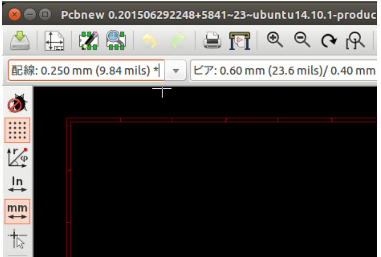
16. もっと配線幅を追加したい場合: デザインルール → デザインルール → グローバルデザインルールタブを表示し、このウィンドウの右下で利用したい配線幅を追加します。これで基板のレイアウトの時にドロップダウンメニューから配線幅を選ぶことができるようになります。以下の例 (インチ単位) をご覧下さい。
