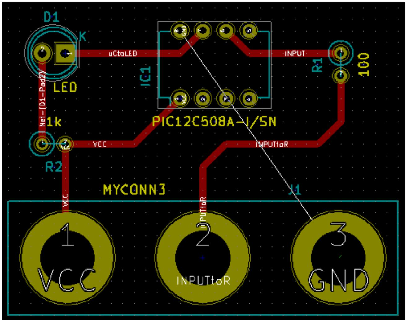
20. PCB の他の銅箔面側での配線を行いましょう。トップツールバーにあるドロップダウンメニューで *B.Cu* ("PgDn" キー) を選択します。配線とビアの追加のアイコン
