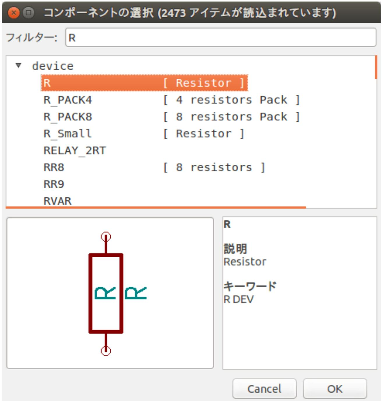
7. その上でダブルクリックします。これにより コンポーネントの選択ウィンドウが閉じられます。回路図シート上の置きたいと思う所をクリックすることでコンポーネントを配置します。
