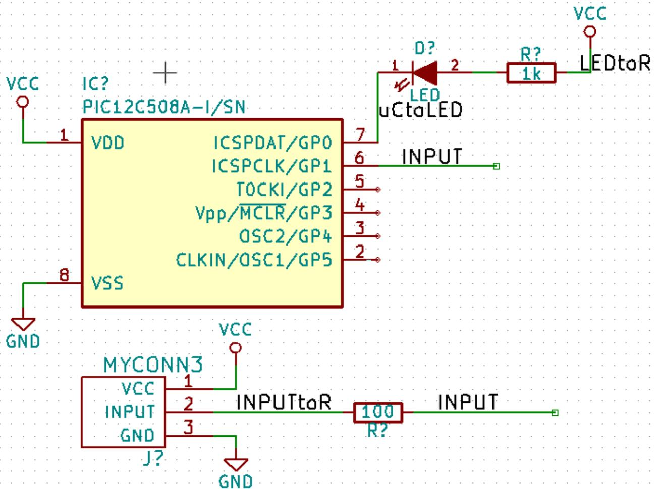
40. それでは接続されていないワイヤに対処しましょう。接続されていないピンやワイヤは KiCad にチェックされた時に警告されます。これらの警告を避けるため、ワイヤが接続されていないのが意図的であることをプログラムに指示することができます。
