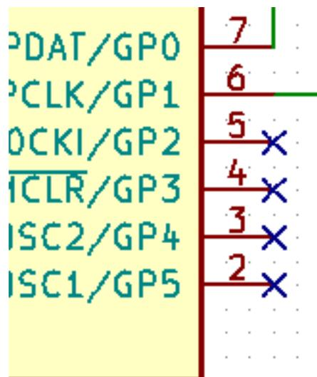
42. 見えない電源ピンを持つコンポーネントがあります。左ツールバーの 非表示ピンを表示のアイコン
