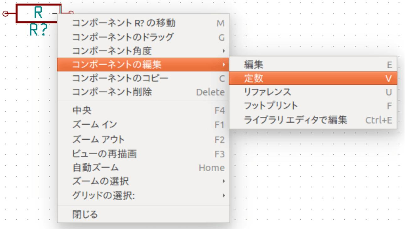
11. フィールド定数の編集のウィンドウが表示されます。現在の定数の *R* を *1k* に置き換えます。OK をクリックします。
